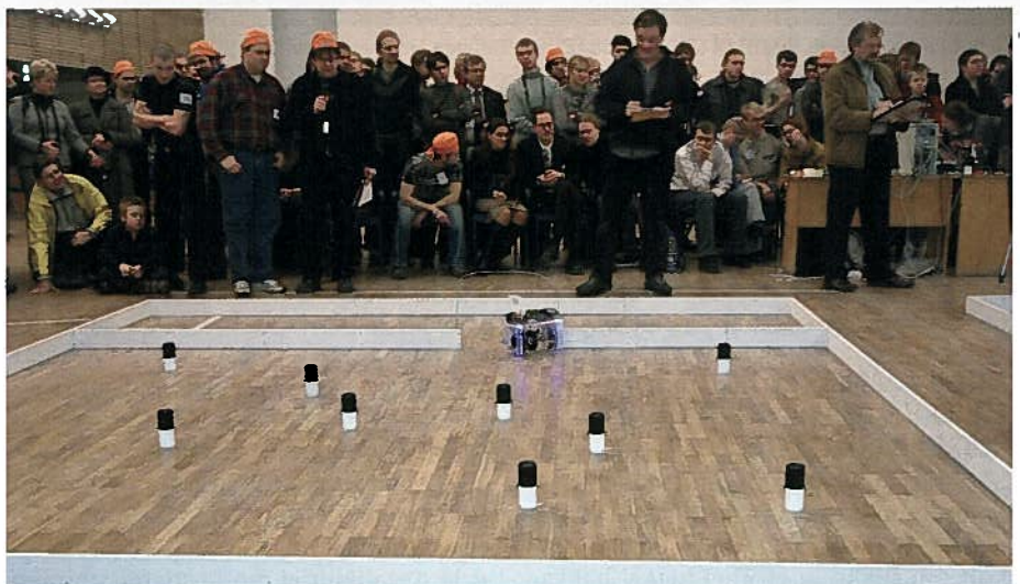
ROBOTEX 2004. 2004. aasta robotivõistluse ülesandeks oli ehitada robot, mis leiab etteantud mõõtmetega võistlusplatsil üles objektid ja pöörab need ringi (peapealt jalgadele). Robot pidi startima selleks ettenähtud alalt ning läbima stardi ja objektide vahel paiknevas seinas asuva värava. Roboti mehaaniline ühendus väljapool platsi paiknevate esemetega oli keelatud, samuti oli keelatud inimese sekkumine roboti juhtimisse võistluse ajal mis tahes ühenduse abil. Robotile oli võistlusplatsil tegutsemiseks antud 10 minutit.
